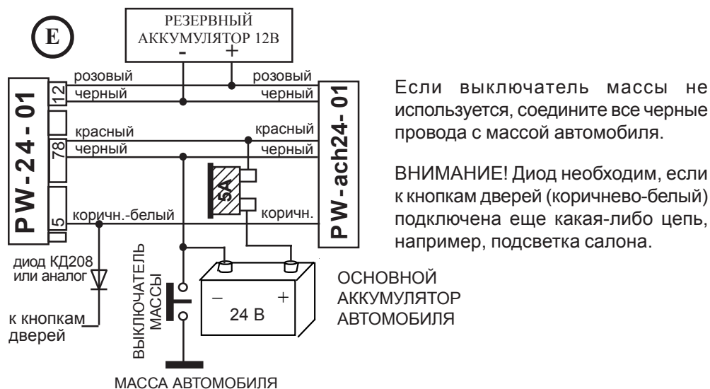
Рис.3. Подключение резервного аккумулятора и контроллера заряда PW-ach24-01.
